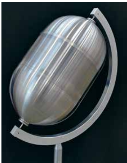
TWI har hjälpt till med att undersöka möjligheterna att använda SSFSW-tekniken på titanlegeringar för uppskjutning av bränsletankar för rymdfarten.
