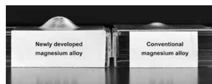
▲ Jämförelse av en nyutvecklad och en konventionell magnesiumplåt efter att de utsatts för en Erichsen-test. Foto: National Institute for Materials Science
