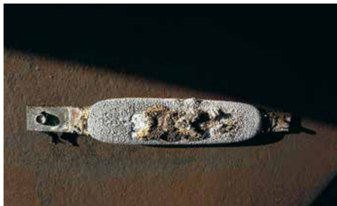
Offeranod (Zn eller Mg) på skeppsskrov av stål.
