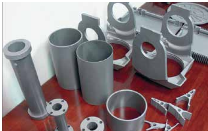
Komponenter av Beralcast gjutna med vaxursmältningsmetoden.
