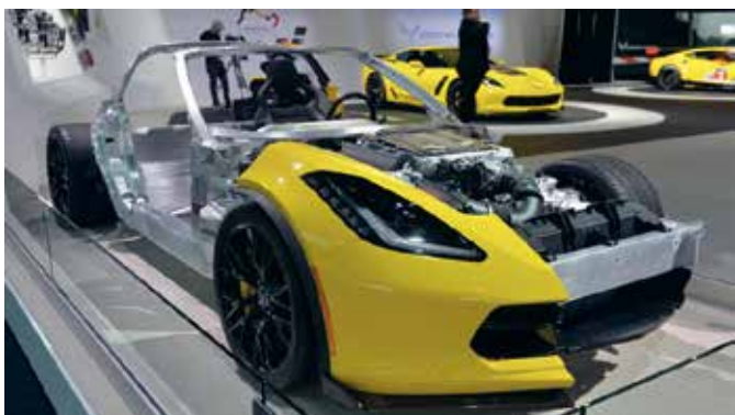
▲ 2014 började GM använda sin patenterade process för punktsvetsning av aluminium som kunde bygga de lättaste, starkaste och bästa Corvetterna sedan introduktionen 64 år tidigare.
