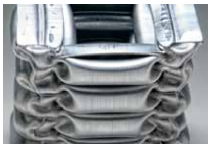
Deformationsprovning av en höghållfast aluminiumlegering. ►
