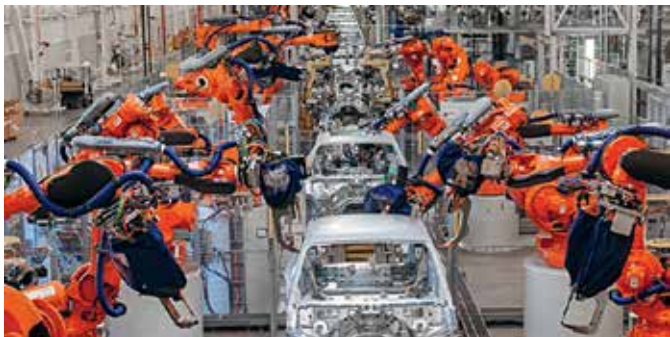
▲ 2014 började GM använda sin patenterade process för punktsvetsning av aluminium som kunde bygga de lättaste, starkaste och bästa Corvetterna sedan introduktionen 64 år tidigare.
