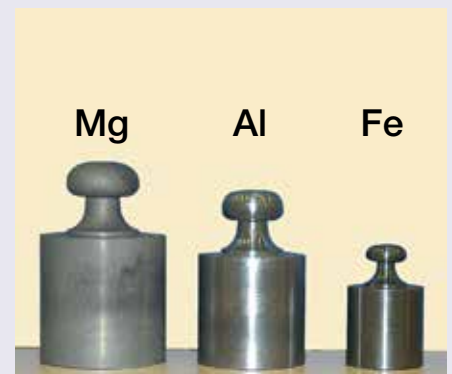
De tre metallstyckena har alla samma vikt, 1 kg, men olika storlek, vilket visar magnesiums låga densitet.
