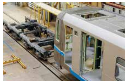
Aluminiumvagn och hjulboggie på samsättningslinjen vid Mytishchi Metrovagonmash, Ryssland i april 2012. Verket är känt för att bygga tunnelbanevagnar.
