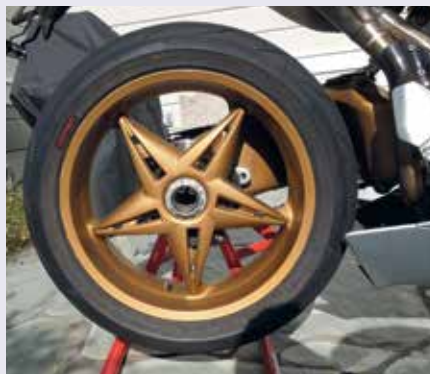
Komplett magnesiumhjul till en motorcykel.
