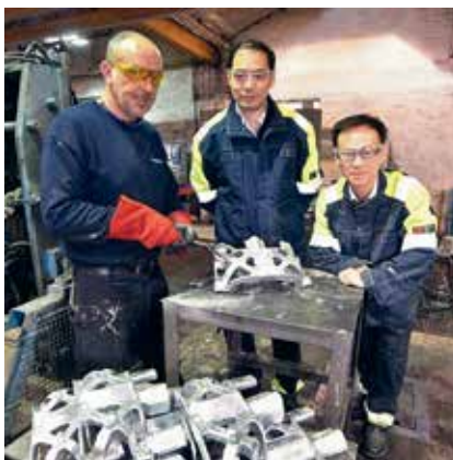
◀ Gjutförsök vid Sarginsons Industries med den nya aluminiumgjutlegeringen på en Jaguar Land Rover-komponent.
