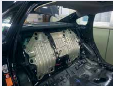
Magnesiumplåt, utvecklad av Renault Samsung Motors och POSCO, installerad i ett fordon som baksätesstöd.
