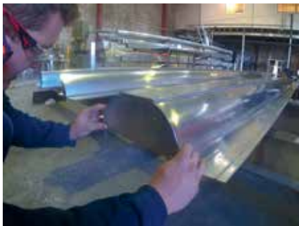
De färdiga skidorna svetsas till position på skrovet. Hålet används som bränsletank.
