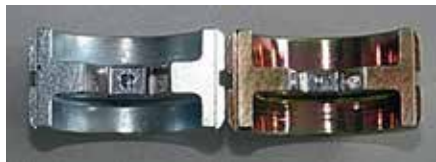
▲ Fig 5. Felaktig och riktig pressning av en kabelhylsa av aluminium.
