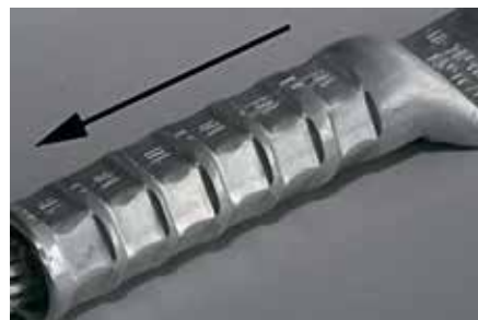
▲ Fig 10. Upprepad pressning sker i riktning mot ledaren.
