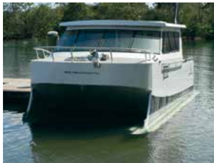
Den 7 m långa båten med skidorna doppade vid låg fart eller förtöjd vid Fingal Boat Harbour, Northern New South Wales.
