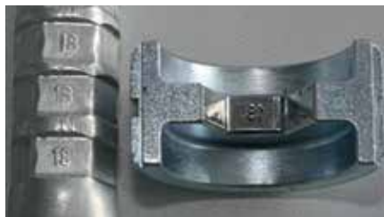
▲ Fig 4a. Arbetande sexkantigt pressningsverktyg på den elektriskt handdrivna pressmaskinen Klauke NK 22 (se fig överst).
