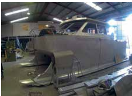
Tryckprovning av skidorna före svetsningen mot fartyget – skidornas hålutrymme håller bränslelasten på mer än 150 liter vardera.
