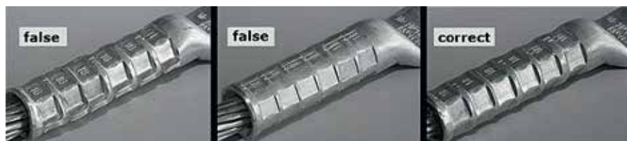
▲ Fig 5. Felaktig och riktig pressning av en kabelhylsa av aluminium.
