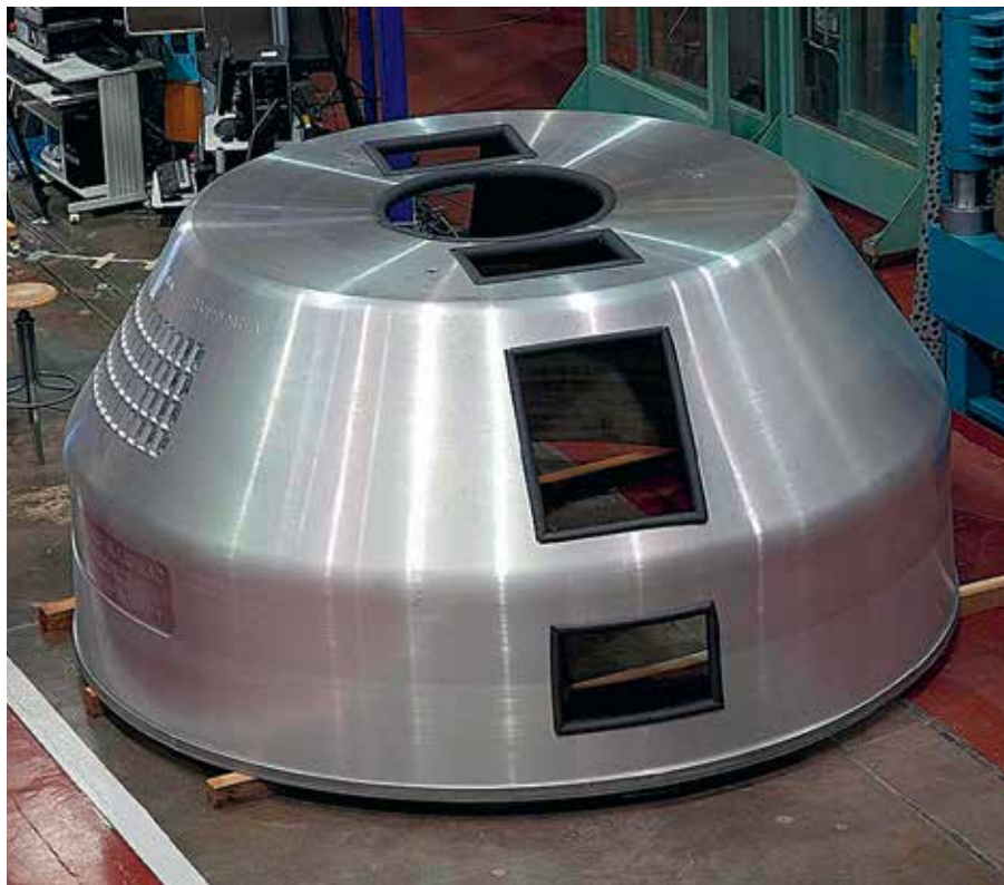
Trycksvarvad modell av det främre trycktäta skottet till en av NASA:s besättningsmoduler av Orion-typ. Modellen Orion FPVBH tillverkades av en standard aluminiumlegering av Wagner and Domack. Utvärderingen ska visa om trycksvarvning gav det resultat man förväntade sig. Om man blir nöjd med resultatet ska nästa modell göras i aluminium-litium, ett mer avancerat och lättare material. Foto: NASA/Jim Baughman.
