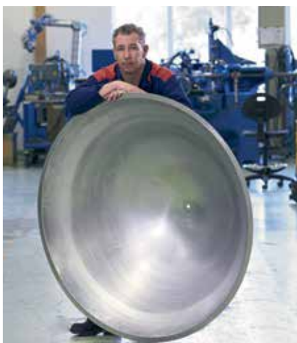
Trycksvarvad parabol i 3 mm aluminium med diameter 1,2 m och höjd 70 mm. Tillverkad av Hermanders i Töreboda.
