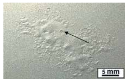
Fig 2. Filiformkorrosionsattack på aluminiumdel från ett fordon. Pilen visar defekter i färgskiktet där korrosionen startade.
