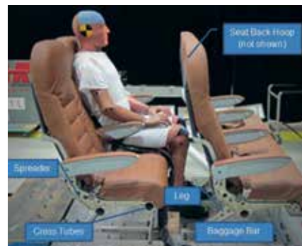
Fig 5. Magnesiummaterial har genom lång provning och utvärdering nu accepterats som konstruktionsmaterial i bärande delar av flygplansstolar.
