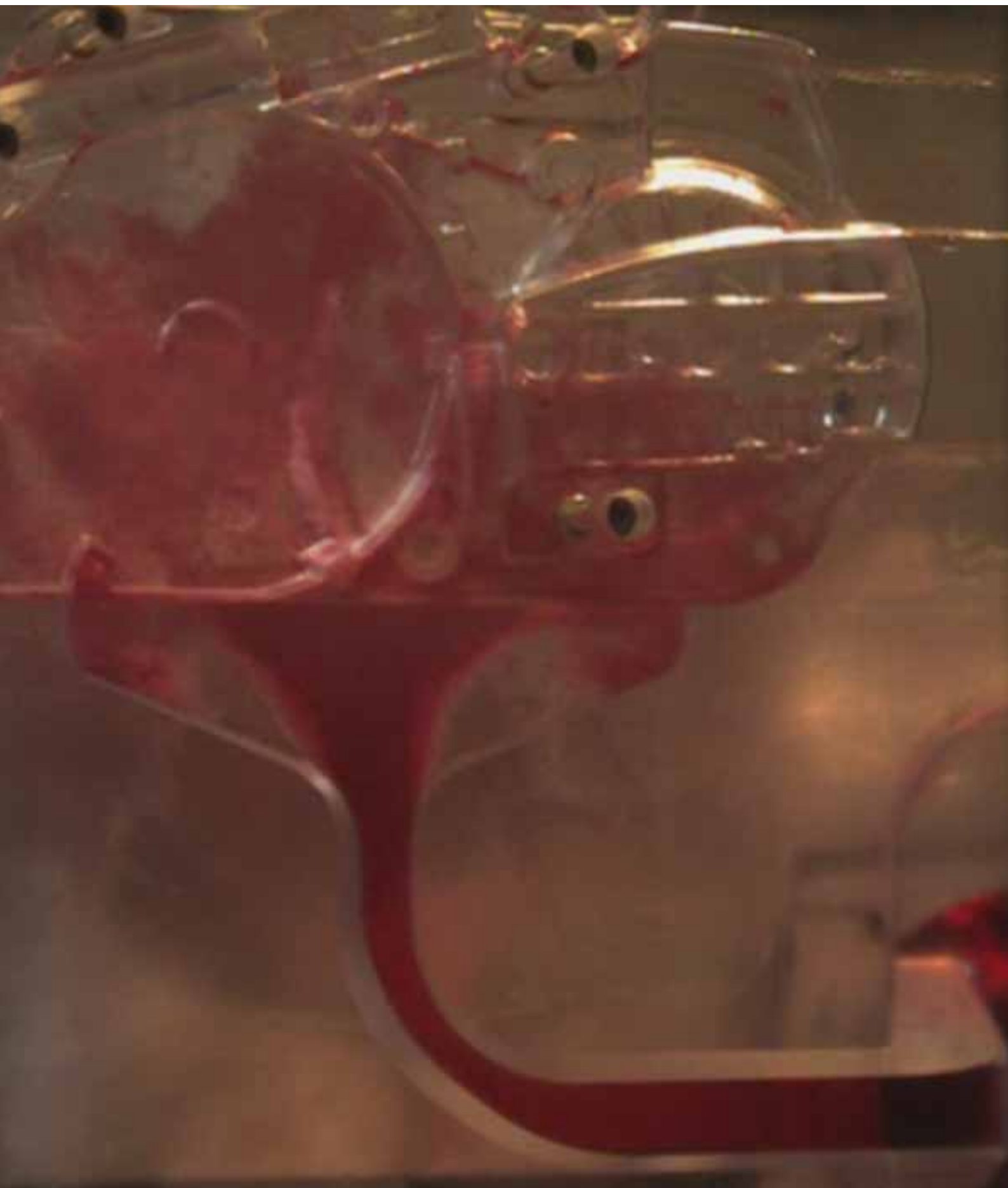
Pressgjutning av färgat vatten i ett plexiglasverktyg
