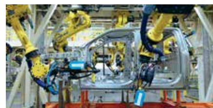
▲ Olika fogningstekniker behövs för att tillverka aluminiumkarosser.
